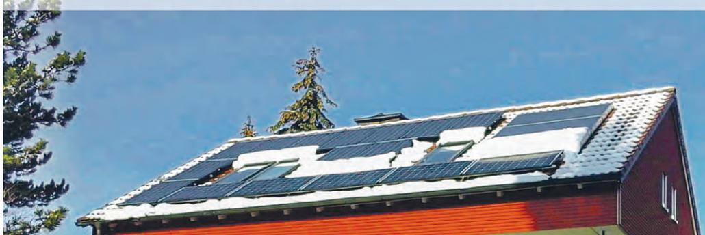
Im Zuge der Generalsanierung bekam unser Haus im letztem Sommer auch eine PV-Anlage. Sie produziert mehr Strom, als wir verbrauchen. Dank Batteriespeicher wird überschüssiger Mittagsstrom am Abend nutzbar. Winterbeispiel vom 31. Januar (Tag mit viel Sonne): 14,5 kWh Sonnenstrom, 11 kWh verbraucht (inklusive Spülmaschine), Rest ins Netz eingespeist.
